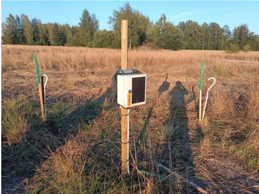
Huokosvedenpainekärjet asennettuina (keskellä mittaussyksikkö, joka myöhemmin siirrettiin penkereen ulkopuolelle)
