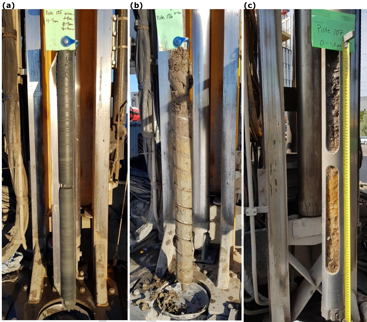
Kuva 3. Näytteen valokuvaaminen ennen näytteen irrottamista ottimesta: (a) Iso suokaira, (b) Kierrekaira, (c) Ikkunaotin. /2/
