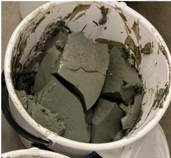
Kuva 2. Esimerkki vajaasta näyteämpäristä, jossa hapettuminen pääsee tapahtumaan. /2/
