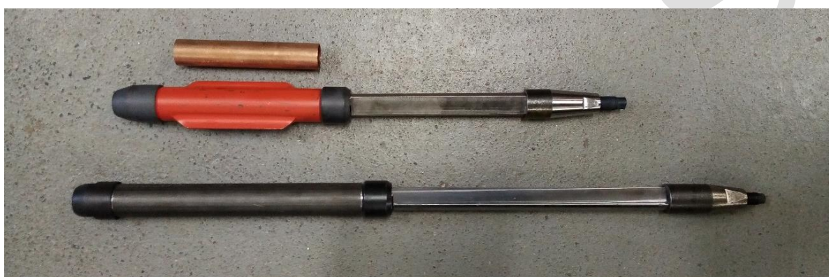
Kuva 11 Pienoismäntäottimen kuparinen näyteputki 150 mm (ylin), pienoismäntäotin \text{Ø}34/26 (keskellä) ja pienoismäntäotin \text{Ø}35/29 (alin). /1/
