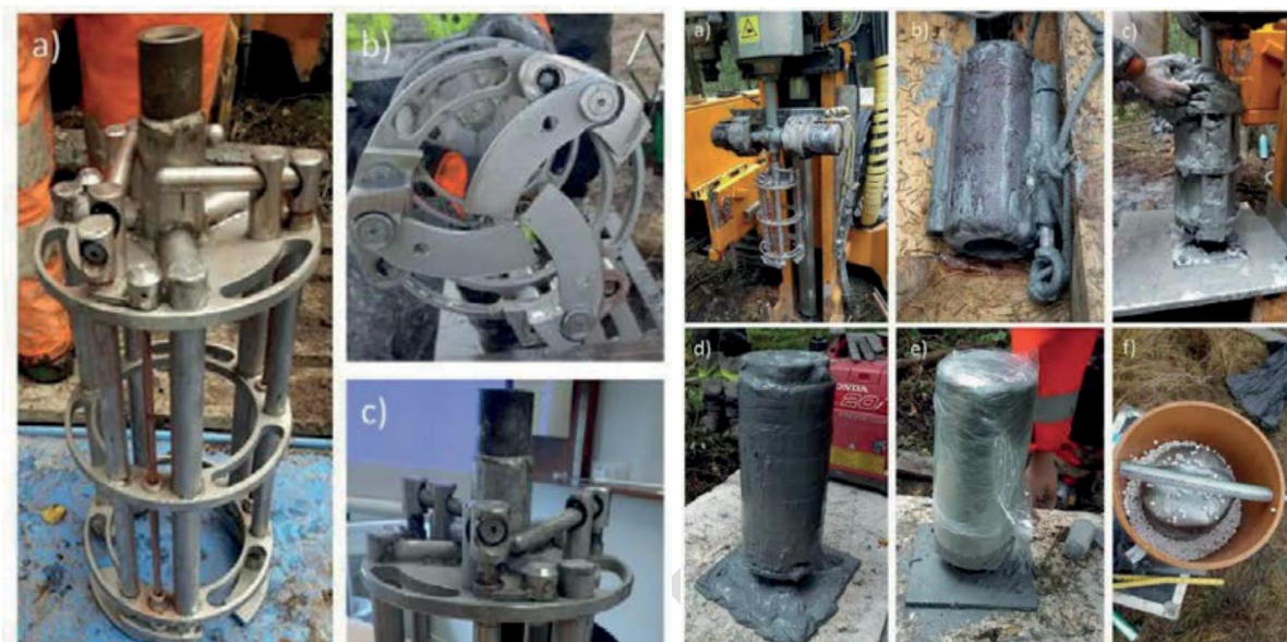
Kuva 19. Miniblokki-näytteenotin (näytteen halkaisija 160 mm) ja näytteenottoprosessi. /8/
