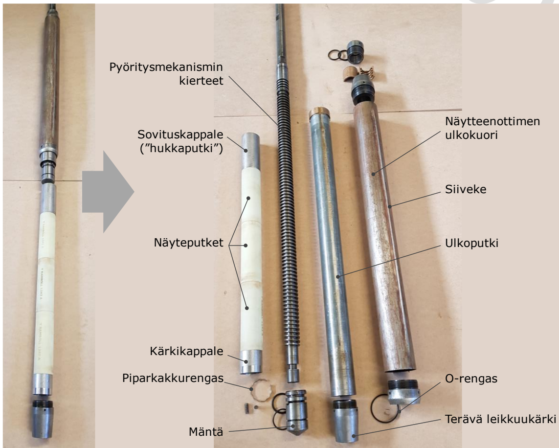
Kuva 2. STII-näytteenotin osittain koottuna (vasemmalla) ja otin purettuna. Näyteputket ovat 170 mm pitkiä ja sisähalkaisijaltaan 50 mm. /1/
