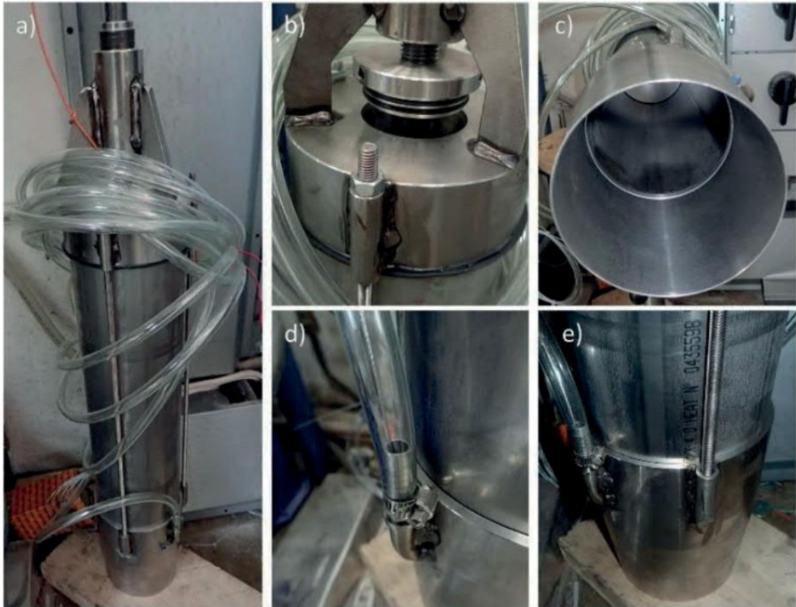
Kuva 20. TUT 132-näytteenotin, jossa on leikkausvaijeri (näkyvä kuvassa d) ja ilmansyöttö ylösnostoa varten. /8/
